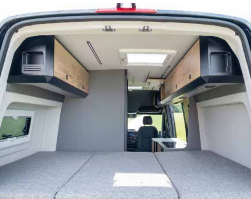
Les extensions latérales de carrosserie permettent d'intégrer un lit arrière de plus de 2 m de long dans le Sprinter
